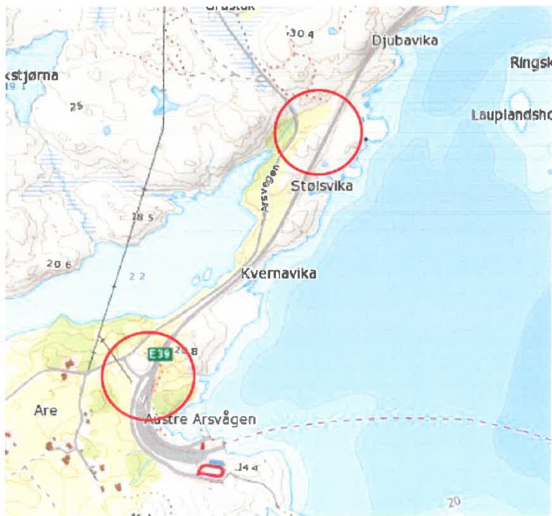
Figur 2 Øverste sirkel viser området for nytt T-kryss mellom E39 og Arsvegen. Nederste sirkel viser hvor anleggstrafikken ville kommet ut på E39 ved billettluken på Arsvågen i gjeldende regulering via Arsvegen.
