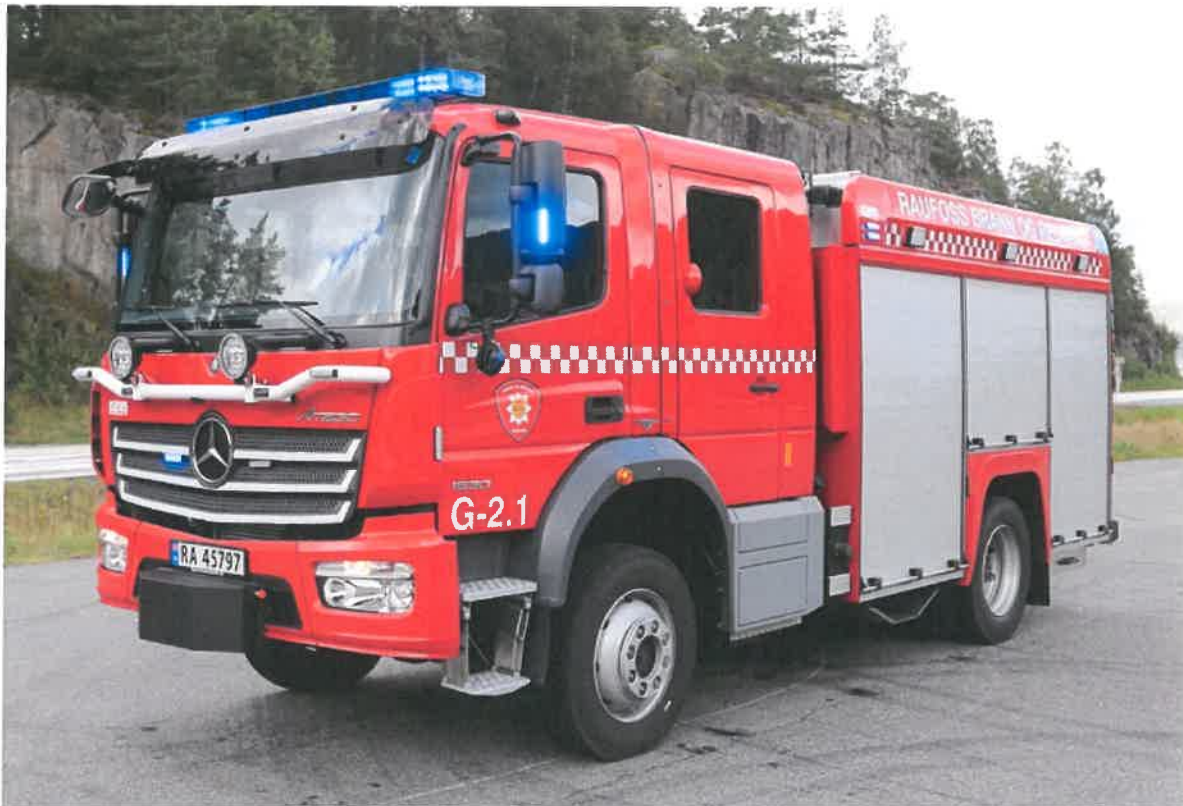
Figur 10 Eksempel på mannskapsbil. Vannkapasitet 2500 liter (foto: Egenes Brannteknikk AS).
