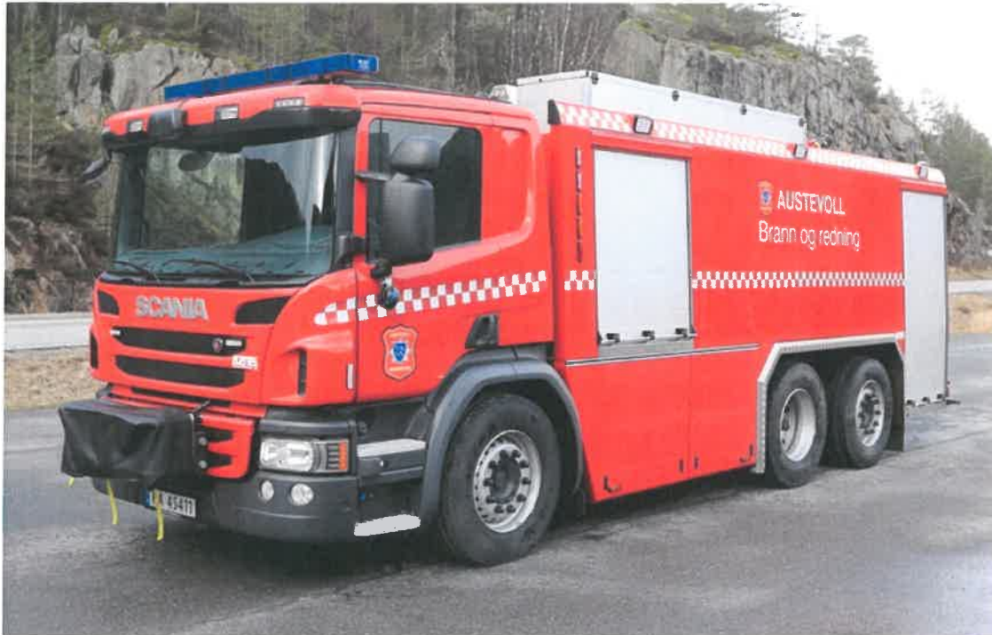
Figur 12 Eksempel på tankbil, kapasitet 10 000 l vann (foto: Egenes Brannteknikk AS)
