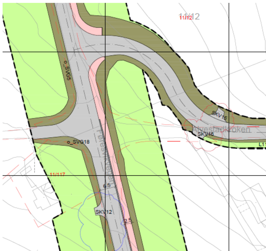
Bilde 6: rød og blå markering viser avkjørsler som er opparbeidet og som tas med i planen for Føresvikvegen fv. 890
