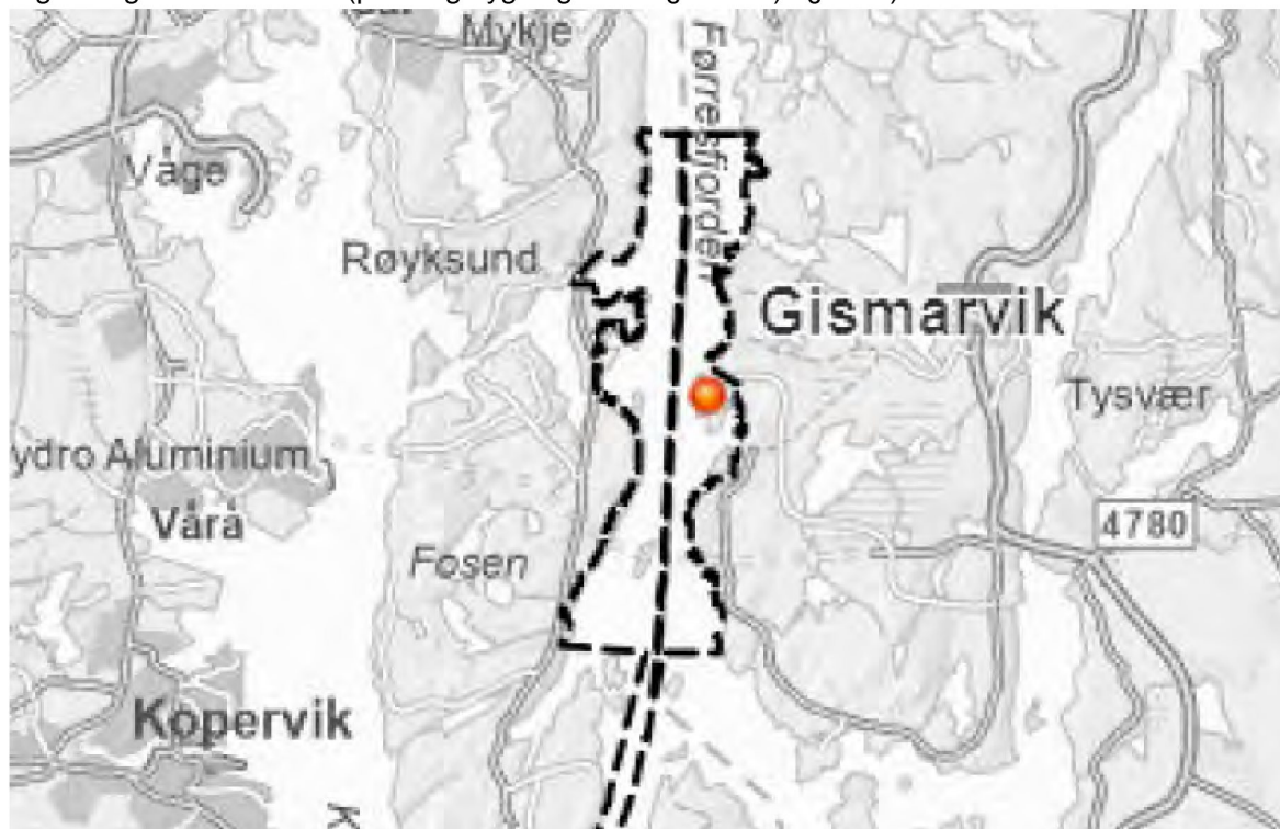
Fig.2 Foreslått planområde i Føresfjorden/ Gismarvik. Formålet med reguleringsplan er å legge til rette for etablering av en terminal for mottak og mellomlagring av CO2 med tilhørende kaianlegg, inkl. nødvendig infrastruktur.
