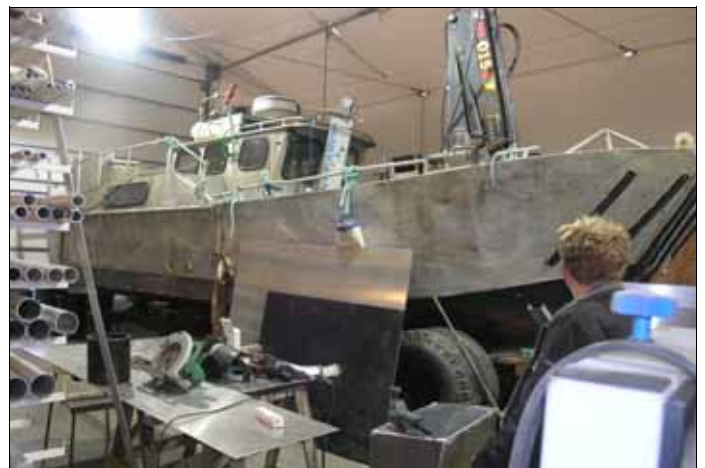
Døme på oppdrag er denne dykkarbåten tilhøyrande firmaet Aqva Dykk kor det er skifta bakre del, og kor dei skal skifta to motorar.
