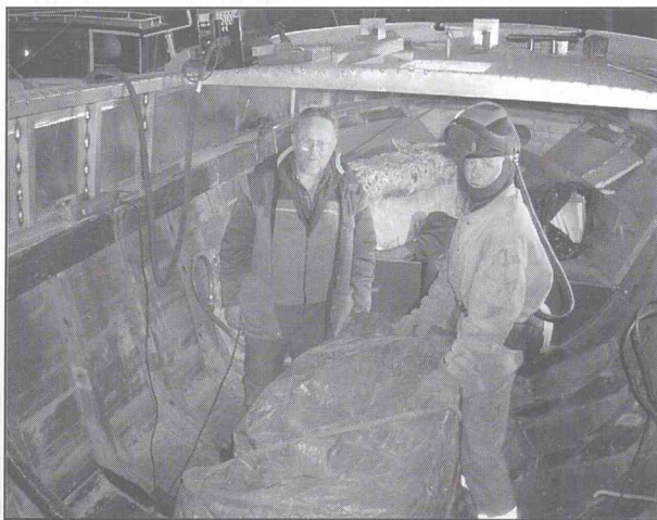
Lars Sigmund og Geir Vidar Heskja står ved motoren i botnen av ein 31 fots båt som dei arbeider med inne i båthuset. Dei er godt kledde i den kalde trekken som står rett inn i båthuset. Her skal dei setja på nytt og større overbygg. Båten vil få betydeleg meir plass og rom under det nye overbygget.
