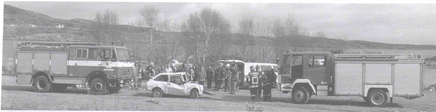
Her er det festa kjetting i begge endar av den samanpressa bilen i midten. Ved hjelp av vinsj dreg brannbilen t.h. fronten av bilen tilbake mot opprinneleg form.
